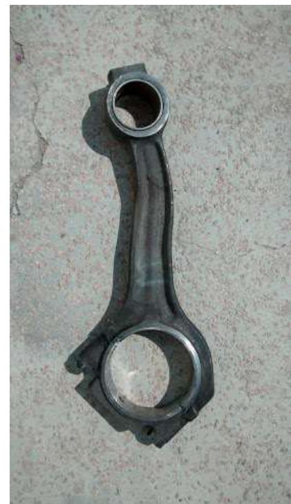
Cedimenti della biella per carico di punta
