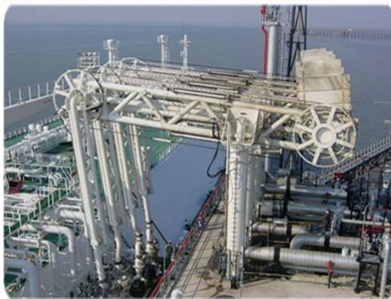
Una nave del tipo a membrana (a sinistra) collegata al gruppo di bracci per lo scarico di un terminal di rigassificazione. Fonte: www.fmtechnologies.com
