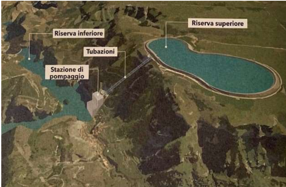
Centrale idroelettrica a due bacini
