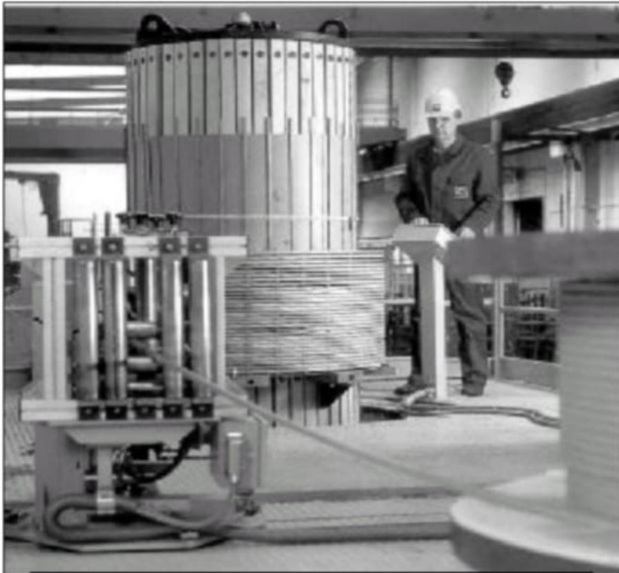
In particolare, nei trasformatori trifase in resina l'avvolgimento in bassa tensione è realizzato con un unico nastro di alluminio di altezza identica all'avvolgimento in alta tensione. L'avvolgimento è normalmente realizzato in nastro di alluminio perché il suo coefficiente di dilatazione termica è molto simile a quello della resina, per cui, al variare della temperatura della macchina, le tensioni meccaniche che si generano sono molto limitate.
