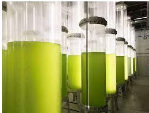
Figura 4: Esempio di coltivazione microalgale in un sistema chiuso tubulare [28]
