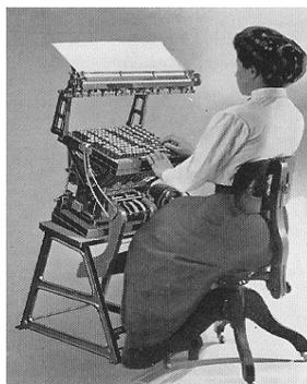
*Fig. 18 - Punzonatrice Automatica - Modello Censimento Powers*
