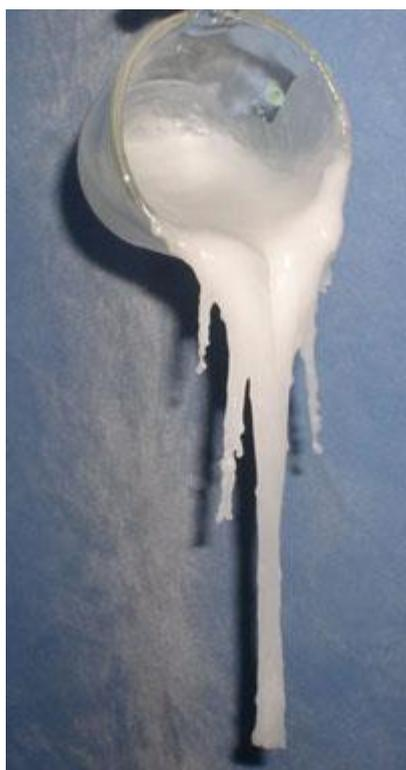
**Figura 26:** Cera da solidificazione carburante diesel
