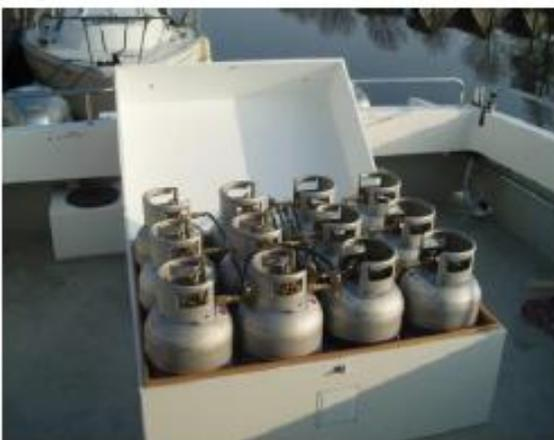
Le piccole imbarcazioni da diporto possono utilizzare bombole domestiche che vengono scambiate quando sono vuote. [fig 29]
