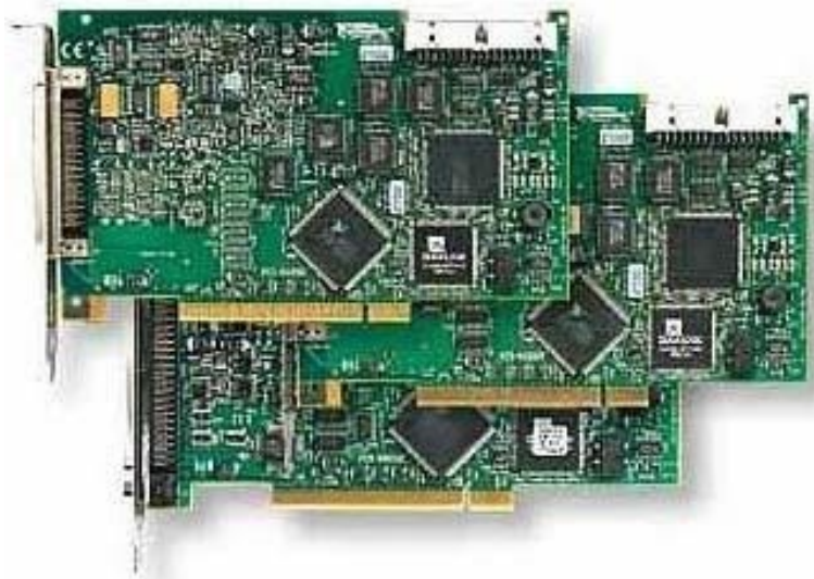
Fig. 6.9: Esempio di scheda DAQ innestabile nel PC
